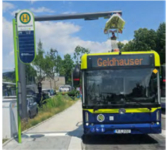
Pantographenladung eines E-Busses an der Endhaltestelle Höllriegelskreuth
